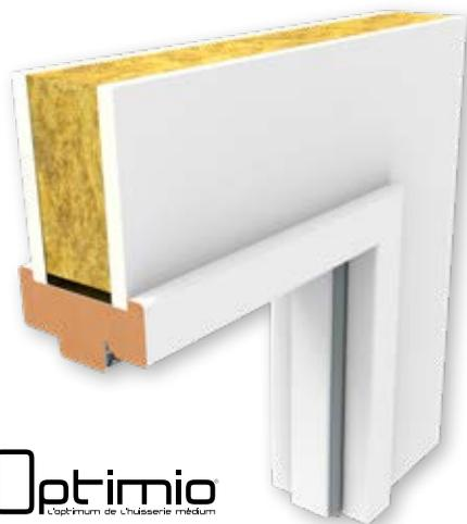
Huisserie en MDF hydrofuge enrobage papier blanc (protégé par un film transparent) pouvant être peint disponible en 5 sections (monobloc jusqu'à 90 mm) largeur 45 mm
